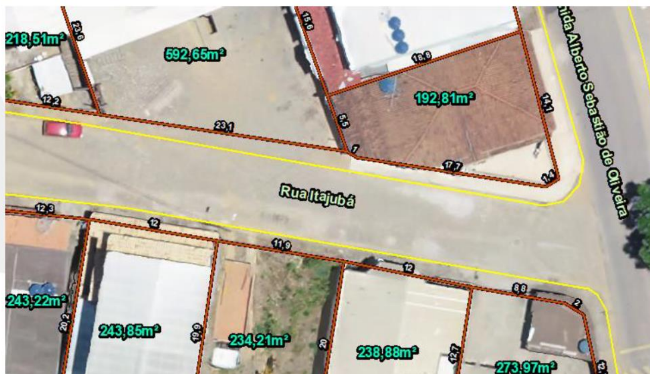
Figura 3: Restituição estereofotogramétrica em ortofoto com GSD de 5 centímetros.
